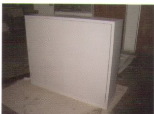
Feeder Pillar Door
